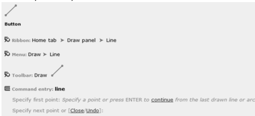
Slika 6. Izvođenje naredbe Line
