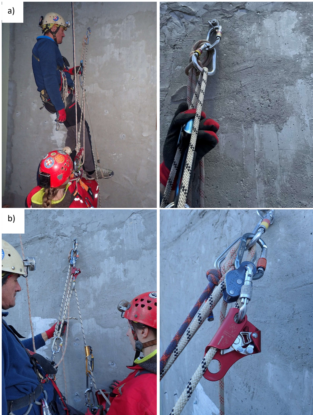
Slika 15: Sistemi podizanja unesrečenog iz „šlinge“ ( Slika 15a: spašavatelj je znatno teži od unesrečenog; Slika 15b: spašavatelj je znatno lakši od unesrečenog)
